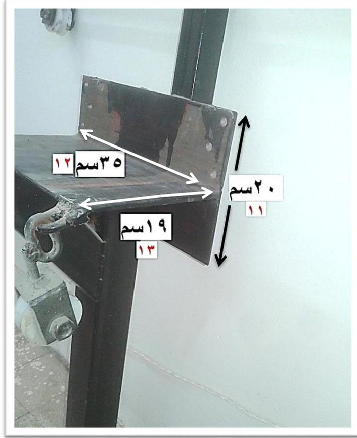
(١١) - وهو مستطيل بشكل رأسي طولها ٢٠ سم و عرضها ٣٥ سم و يثبت فيه من الأمام العمود رقم (١٠) ومهمته به ٣ فتحات شكل رقم (٧) وذلك لربط القضيبين شكل رقم (٢٢) بالجزء العلوي من مقدمة الجهاز بالإضافة لربط الأجزاء رقم (٩) - (١٠) - (١) بالجزء العلوي من مقدمة الجهاز
