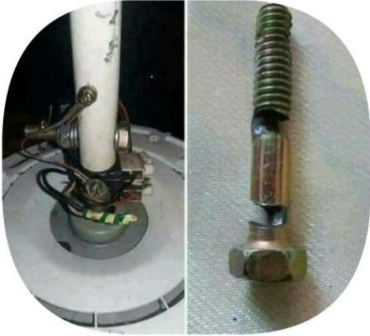
مع بداية موسم الحر ، يجأ بعض الناس إلى استخدام المراوح السقفية لذى ينبغي التأكد من سلامة البرغي الذى يربط بين جزء المروحة السفلي وبين جزئها العلوي لأنه بمرور الوقت و لكثرة الاستعمال و الحركة أثناء التشغيل يتآكل و يصبح عرضة للكسر كما هو موضح بالصورة و بالتالي يؤدي إلى سقوط المروحة و التسبب بأضرار .
