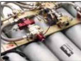
يستخدم في حماية خزانات وقود الطائرات من مخاطر الحرائق كونه غاز خامل يستخدم في دفع سوائل ومواد الاطفاء
