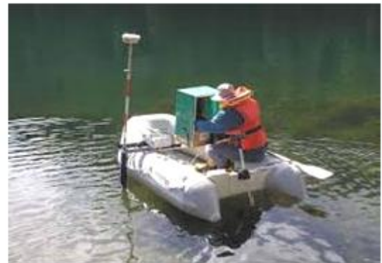
الرفع المائي بجهاز الرادار الصوتي و الجي بي أس
