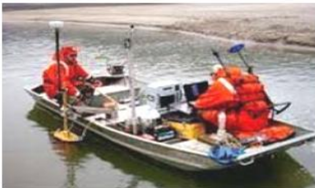
الرفع المائي بجهاز الرادار الصوتي و الجي بي أس
