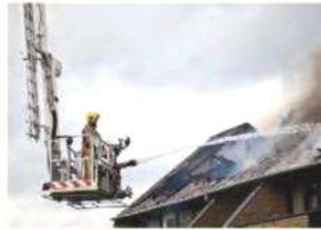
Elevated master stream devices can be mounted on aerial apparatus مكافحة حرائق المباني عن طريق عريّة السلم الدوار
