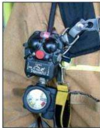
جهاز إنذار مدمج مع جهاز التنفس
